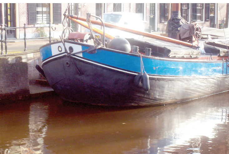
14. De traditioneel geworden kenmerkende kop van een stalen Hasselter aak, hier De Dageraad in de stadsgracht in Hasselt. Dit schip werd in 1905 gebouwd op de werf van Appelo in Zwartsluis. Foto J. Holthuis.
