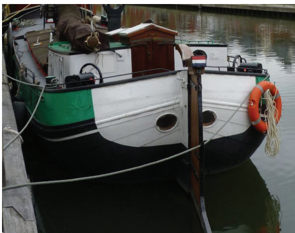
15. Voor- en achterschip van een in Friesland gebouwde klipperaak. De skûtsje-traditie van Friese werven is onder andere zichtbaar aan de in het midden geplaatste toegang tot de roef.
